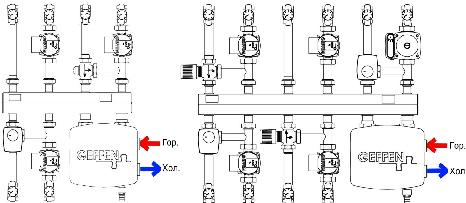
Рис а Общий вид коллектора после переворота модулей
