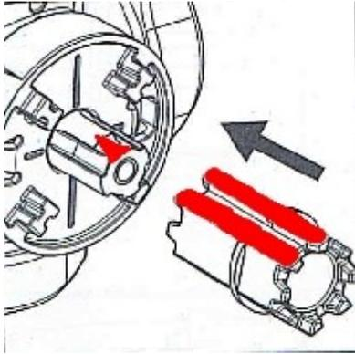
Путем поворота втулки, по часовой стрелке, повернуть затвор клапана, чтобы он перекрывал порт.
