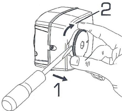
2. Открутить винт, против часовой стрелки, удерживающий электропривод на клапане при помощи крестовой отвертки.
