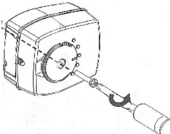
3. Снять электропривод. Одеть втулку на шток привода совместив пазы.
