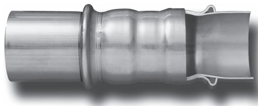
Графика 2: Пресс-соединение Mapress после прессования
