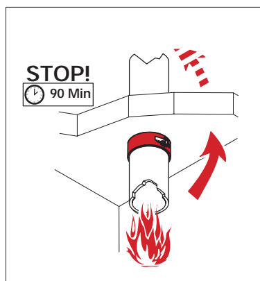
Установка на перекрытии Класс огнестойкости – F 90
