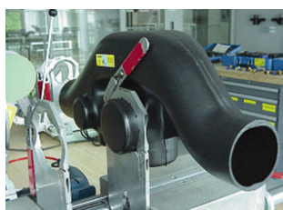
1. Зафиксируйте фитинг в сварочной машине
