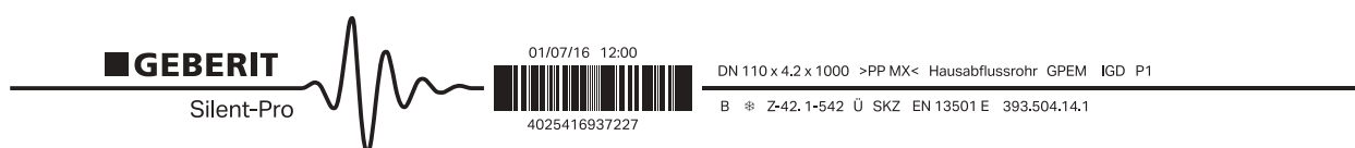
Изображение 1: Данные на трубе Geberit Silent-Pro
