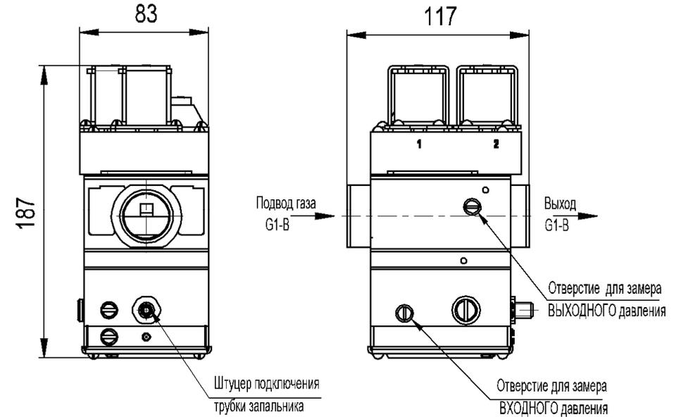
Рис. 1 Газовый блок
