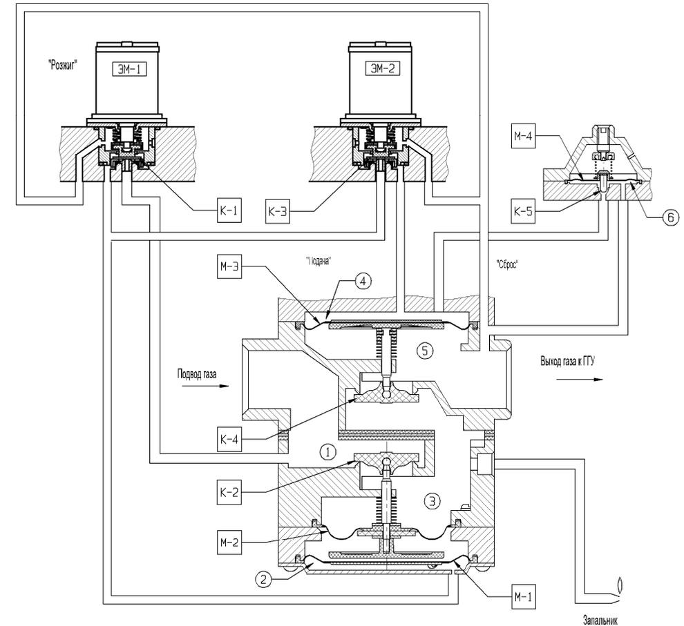
Рис.3 Схема пневматическая газового блока
