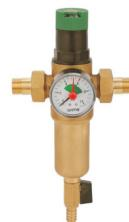
Фильтр со встроенным редуктором давления для предварительной очистки горячей воды от механических примесей - частиц ржавчины, волокон пеньки, песчинок, защиты сантехники, бытовой техники подключенной к водопроводу. Фильтр представляет собой комбинацию промывного фильтра с клапаном понижения давления.
