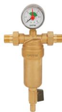
Обладает функциями фильтрации и промывки. С помощью дренажного крана осуществляется прямоточная промывка фильтра, в результате чего загрязнения не поступают в обработанную воду, а остаются снаружи фильтрующего элемента на дне колбы. С поверхности фильтрующего элемента и со дна колбы загрязнения удаляются во время промывки.
