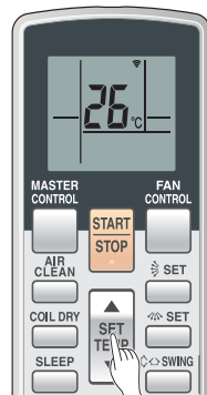
Пример: Установка на 26 °C.
