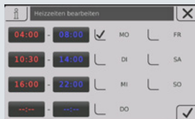
Abb. 2 Ansicht der Heizzeiten (individuell einstellbar)
