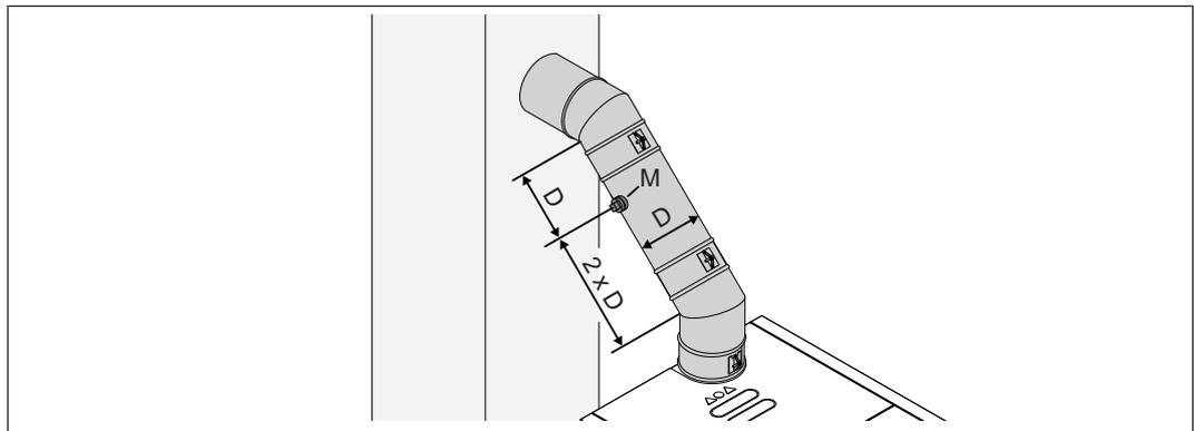
Vor der Messöffnung (M) soll sich in einem Abstand, der etwa dem zweifachen Durchmesser (D) der Verbindungsleitung entspricht, eine gerade Einlaufstrecke befinden. Nach der Messöffnung ist eine gerade Auslaufstrecke in einem Abstand, der etwa dem einfachen Durchmesser der Verbindungsleitung entspricht, vorzusehen. Die Messöffnung ist während des Betriebs der Anlage stets geschlossen zu halten.
