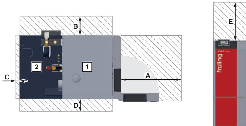
1 ... Pelletskessel PE1 Pellet Unit | 2 ... Brennwert-Wärmetauscher
