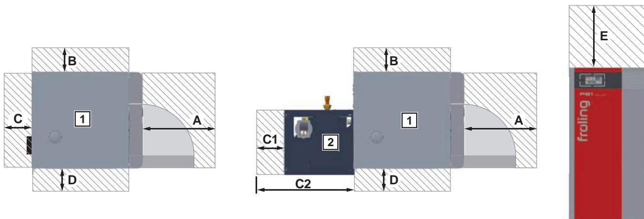
1 ... Pelletskessel PE1 Pellet | 2 ... Brennwert-Wärmetauscher
