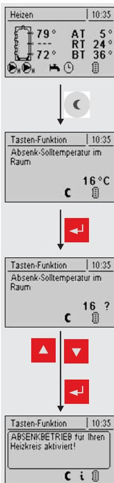
Nach dem Drücken der Absenkbetrieb-Taste wird am Display ein Eingabefeld zur optionalen Änderung der „Absenk-Solltemperatur im Raum“ angezeigt. Wird keine weitere Taste gedrückt, startet der Absenkbetrieb bis zum Ende der nächsten Heizphase oder bis zur Aktivierung des Automatikbetriebs, für den zugeordneten Heizkreis, mit der voreingestellten „Absenk-Raumsolltemperatur“.
