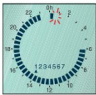
Регулировка периодов работы « **Режима пониженной температуры** »
