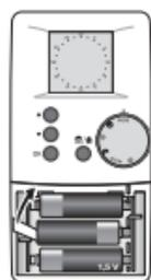
■ Установив колёсико в положение «Auto», нажать в течение 5 секунд на кнопку ▲ появится надпись «CnF»: пульт переведен в режим «конфигурация», посылается запрос на приемник для идентификации.
