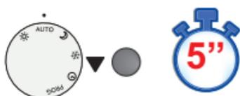
Выбрав на радиодатчике режим "Auto", нажать в течение 5 секунд на кнопку ▲, появится надпись "TEST". На панели управления котла погаснут все индикаторы, кроме термометра, который отображает температуру в виде гусеничной ленты: передача сообщения работает.
