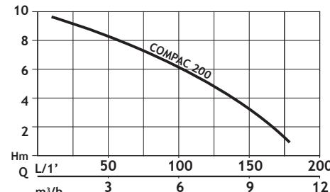
Погружной насос для условно чистой воды. Вал двигателя из нержавеющей стали, однофазная гидравлическая система из пластика NORYL. Насосы COMPAC оснащены 10-метровым кабелем и могут эксплуатироваться в ручном или автоматическом режиме с поплавковым переключателем.
