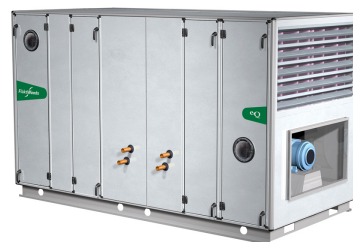
Приточно-вытяжной блок с роторным или пластинчатым рекуператором. Все компоненты встроены: вентиляторы, фильтры, клапаны, рекуператор, охладитель и нагреватель.
