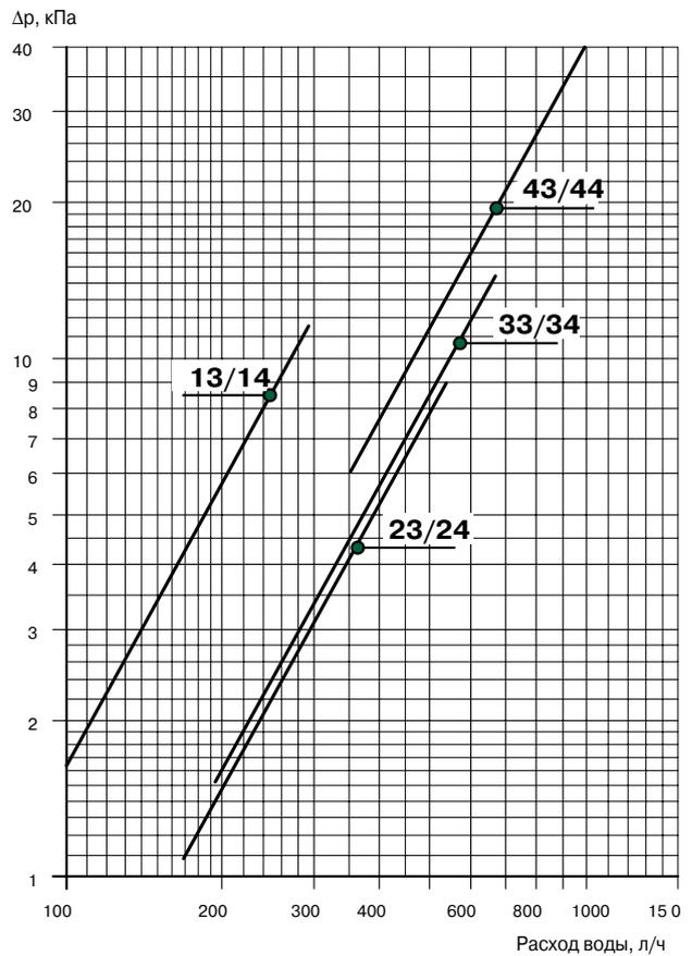
Гидравлическое сопротивление водяного контура фанкойла указано для средней температуры воды 65 °С. Для других температур следует умножить указанные значения гидравлического сопротивления на поправочный коэффициент К.
