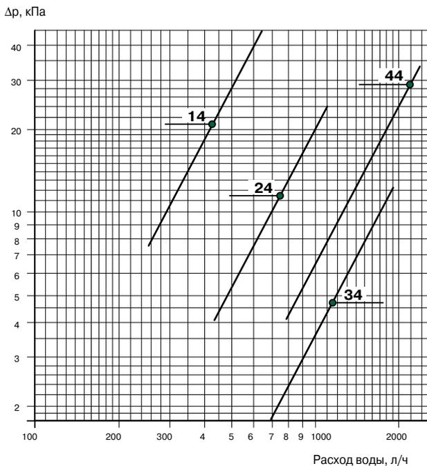
Гидравлическое сопротивление водяного контура фанкойла указано для средней температуры воды 10 °С. Для других температур следует умножить указанные значения гидравлического сопротивления на поправочный коэффициент К.
