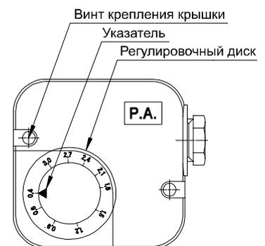
**РЕГУЛИРОВКА РЕЛЕ МИНИМАЛЬНОГО ДАВЛЕНИЯ ГАЗА (P.G. min)**
