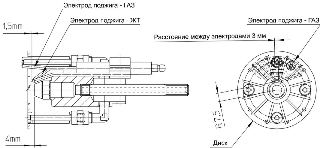
**УСТАНОВКА ЭЛЕКТРОДОВ ДЛЯ ГОРЕЛКИ GM X3**
