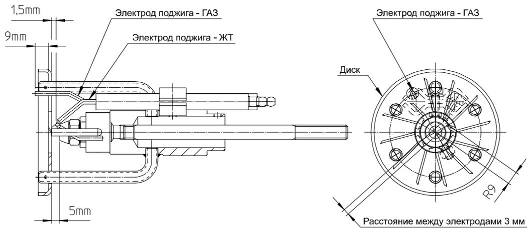
**УСТАНОВКА ЭЛЕКТРОДОВ ДЛЯ ГОРЕЛКИ GM X4**
