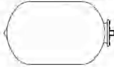
Подключение заливочного бака. Обязательная установка на всасывании.
