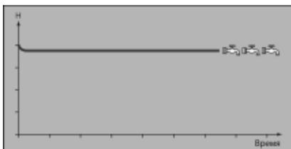
Работа TECHNOPLUS= стабильное давление в системе при изменяющемся расходе воды.
