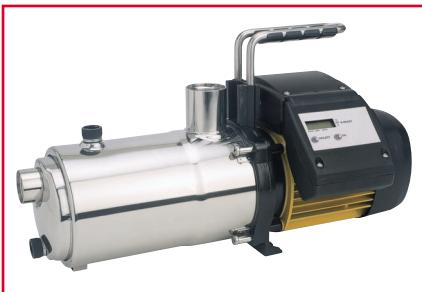
**Бесшумные горизонтальные многоступенчатые центробежные насосы. Включают в себя встроенный программатор подачи воды с четырьмя разными программами на неделю, самовсасывающий клапан, защиту сухого хода и обратный клапан, вмонтированный в патрубок насоса. Высота самовсасывания до 9 метров**
