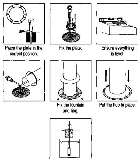
Рис1. Правильно разложите диск. Рис2. Закрепите диск. Рис3. Убедитесь, что все закреплено ровно. Рис4. Будьте осторожны, чтобы не повредить проводам. Рис5. Закрепите диски и сам распылитель. Рис6. Отпустите на место кольцо. Рис7. Стабилизируйте насос.
