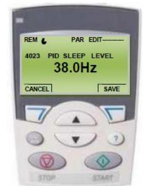
С помощью кнопок
