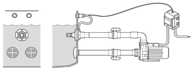
**Насосы рекомендуемые для систем противотока:** WIPER 3 200, WIPER 3 200M, WIPER 3 300, WIPER 3 300M, SILEN 2 200, SILEN 2 200M, SILEN 2 300, NADORSELF 200, NADORSELF 200M, NADORSELF 300, NADORSELF 300M, NADORSELF 400
