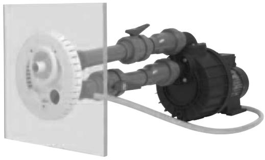
Для бетонных и плёночных бассейнов. Производительность форсунок регулируется от 30 до 70 м<sup>3</sup>/ч. Форсунки противотока можно соединять с насосами мощностью от 1.9 кВт до 4.1 кВт. Насос должен быть установлен как можно ближе к форсунке чтобы избежать потерь напора на трение и добиться максимальной производительности.
