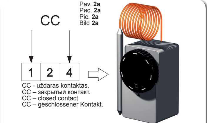
Prieššaliminio termostato patikrinimas. Проверка противозаморающего термостата. Inspection of the antifreeze thermostat. Überprüfung des frostbeständigen Thermostates.
