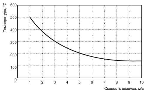
Температура на поверхности ТЭНов воздухонагревателей зависит от скорости потока воздуха через нагреватель и коэффициента теплосъема с поверхности нагревателей. На графике показана зависимость температуры на поверхности нагревательных элементов от скорости потока воздуха. Температура воздуха на выходе составляет около 20 °С.
