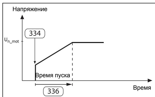
Рис. 52 Начальное напряжение и время пуска.
