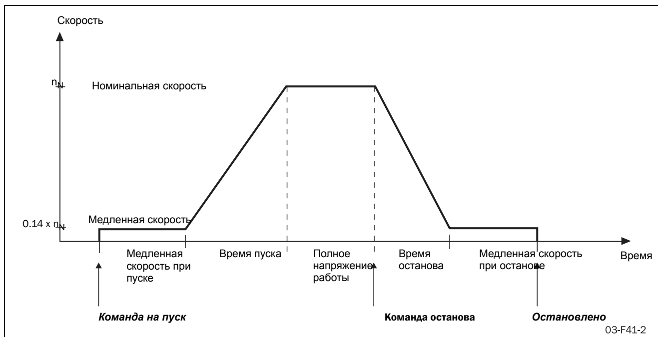
Рис. 47 Медленная скорость при пуске/останове в течение выбранного времени.
