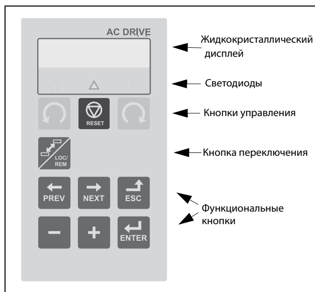
Рис. 82 Дисплей панели управления, светодиодные индикаторы и кнопки
