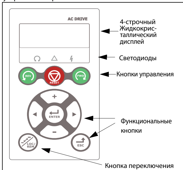
Рис. 78 Панель управления с 4-строчным дисплеем, светодиодные индикаторы и кнопки
