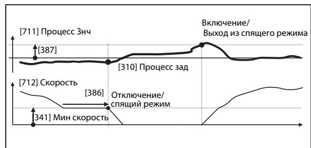
Рис. 105 Отключение/спящий режим ПИД при инвертированном ПИД-регулировании
