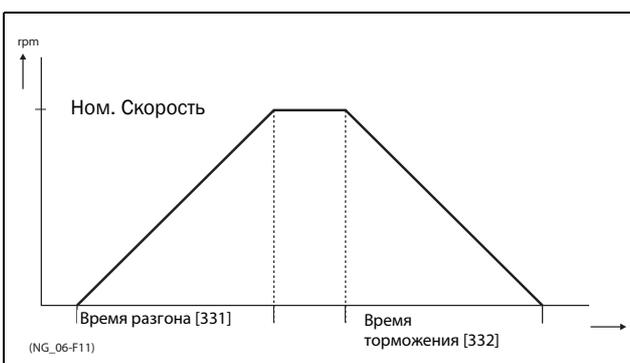
Рис. 91 Время разгона и торможения
