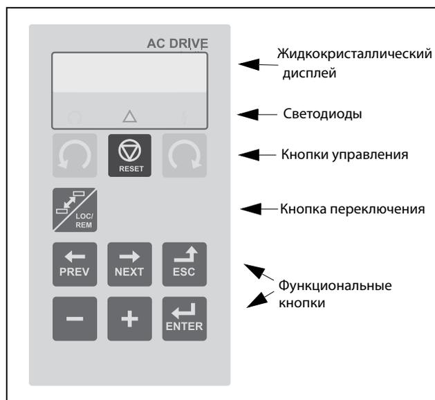
Рис. 94 Дисплей панели управления, светодиодные индикаторы и кнопки
