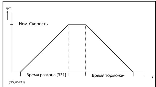
Рис. 111 Время разгона и торможения
