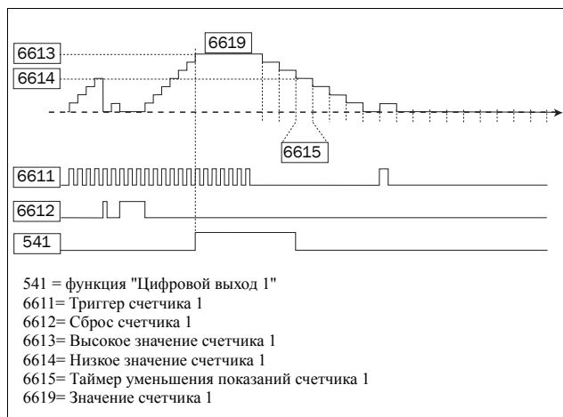
Рис. 103 Счетчики, принцип действия.
