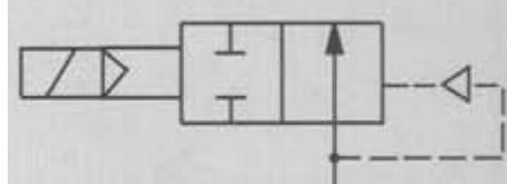
Детальный чертеж нормально закрытого клапана
