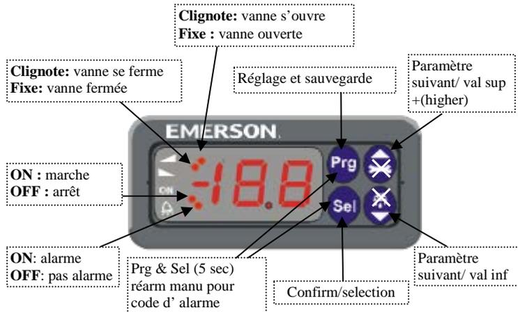
**Réglage des paramètres avec ECD-002:**
