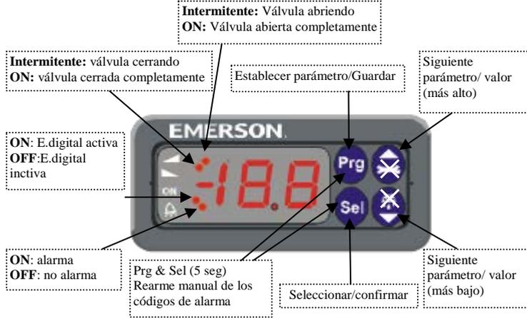
**Configuración de los principales parámetros utilizando el display ECD-002:**
