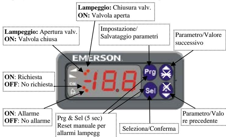
**Impostazione parametri fondamentali mediante ECD-002:**
