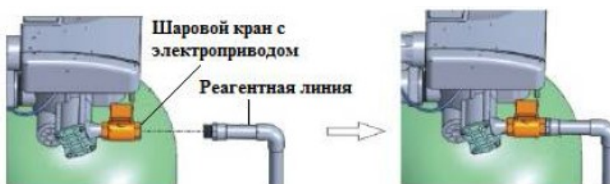
Рисунок 5 — Подключение реагентной линии в установках WS-13,0-Rx-(BS)-WS-20,0-Rx-(BS)
