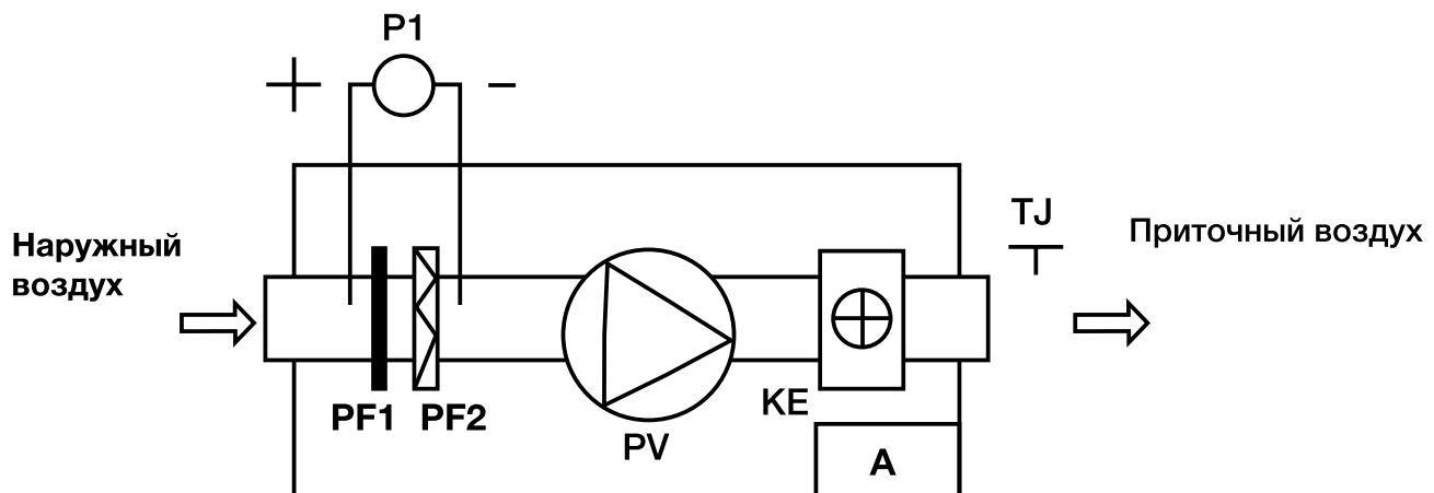
PV — вентилятор приточного воздуха;
