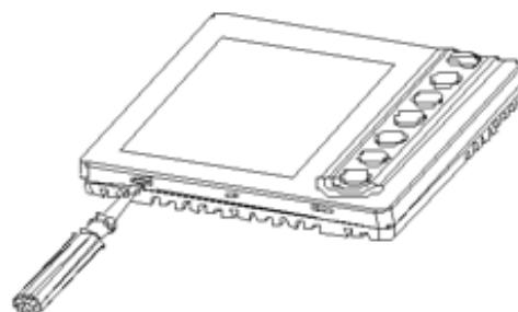
Приставьте корпус пульта к стене и зафиксируйте его двумя шурупами.
