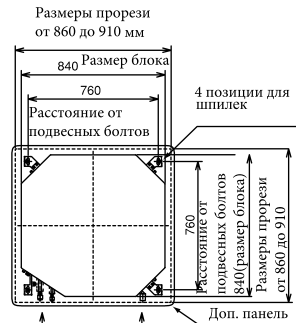
Сторона подсоединения труб Подсоединение дренажной трубы Подготовка места установки блока в подвесном потолке
