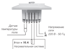
Рисунок 4. Схема подключения к терморегулятору
