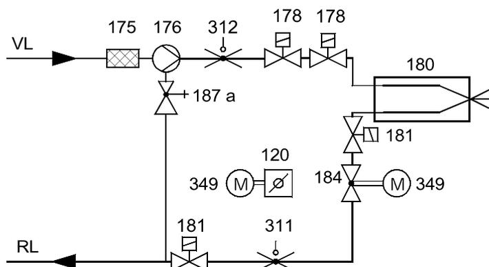
У TRD 604 / 72h контрольные приборы (поз. 311, 312) должны быть или проверены в соответствии с особой конструкцией, или выполнены в двойном количестве.
