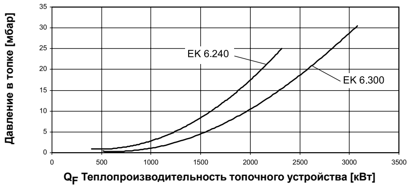
Потеря давления газа горелки EK 6.240 / 300 G-RU2
