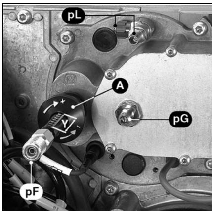
Помимо изменения подачи воздуха **регулирование воздуха в головке горелки** влияет также на зону смешивания и давление воздуха в сопле горелки. Поверните винт **A**:
