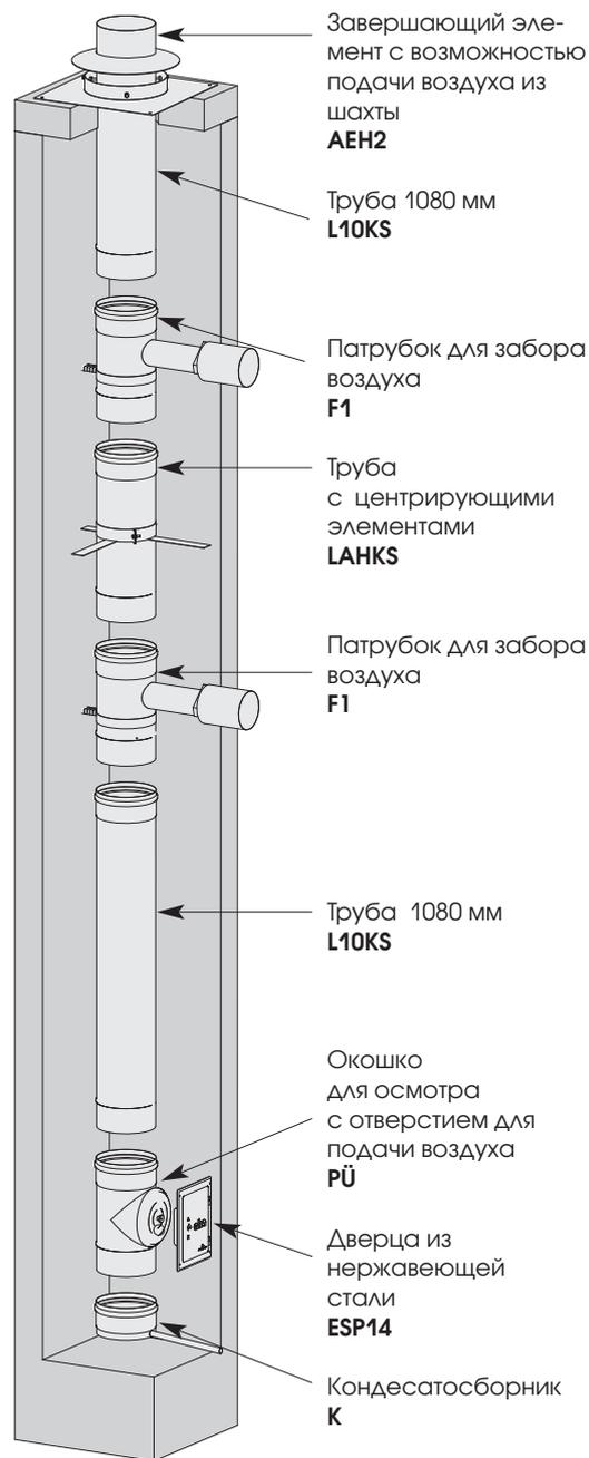
**6.) Система каскад для отопительных систем на жидком и газообразном топливе - низкое давление**
