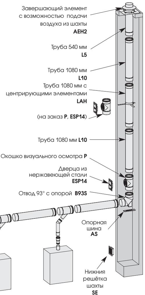
**7.) Коаксиальные дымоходы и двустенные системы - высокое давление**
