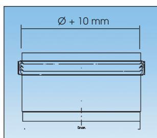
Перед тем как соединить два отрезка трубы каждое уплотнение следует смазать смазкой. Температура отходящих газов не должна превышать 200°C.
