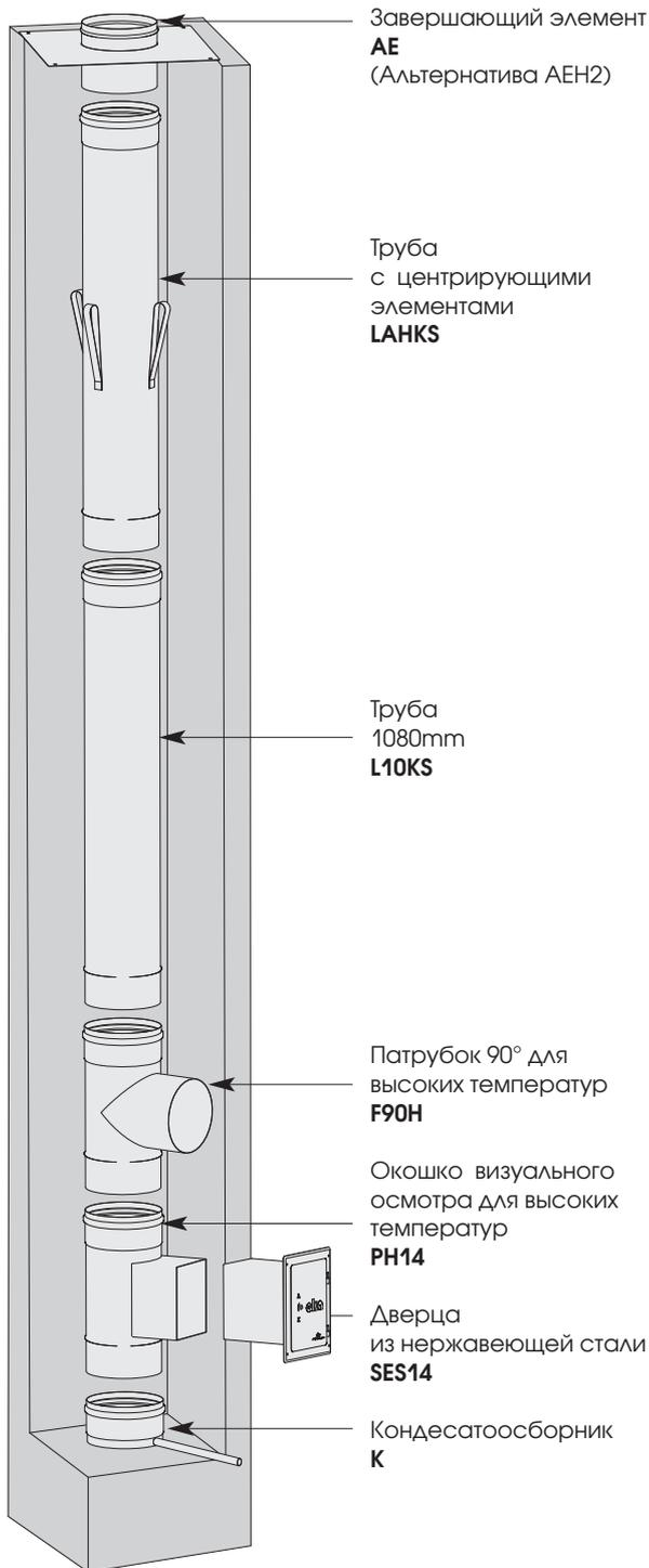
**3.) Гибкая система из нержавеющей стали «эка-флекс» для отопительных установок на жидком и газообразном топливе - низкое давление**
