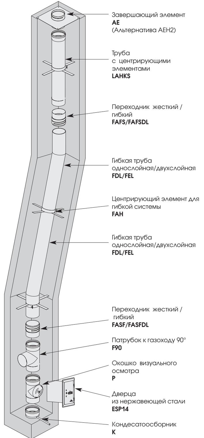
**4.) Дымоход на жидком и газообразном топливе - высокое давление (с надувными горелками)**
