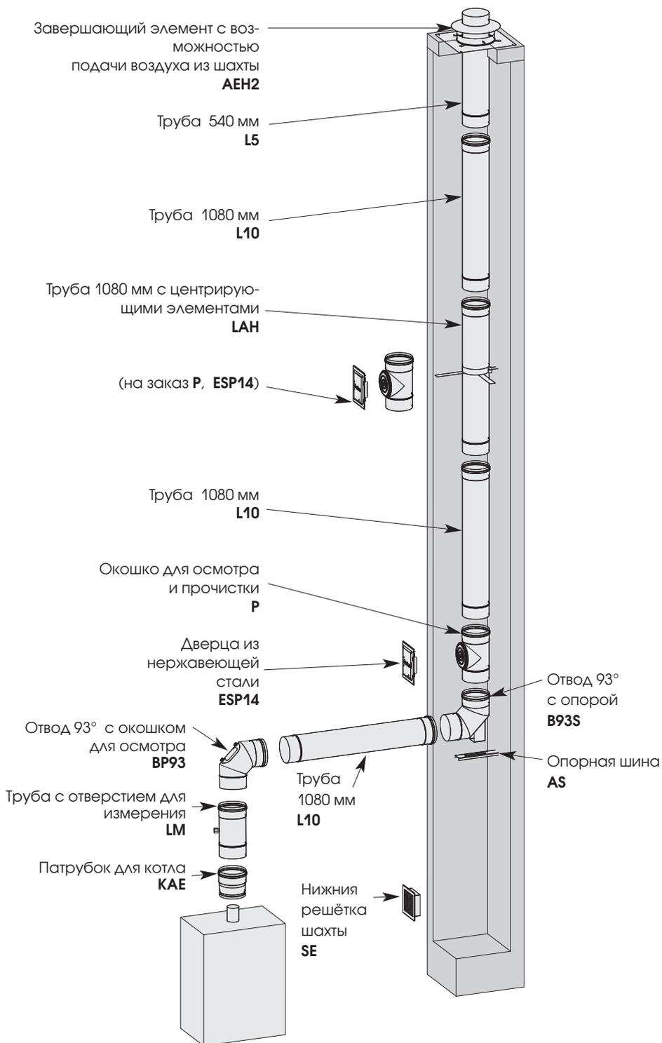
**5.) Дымоход с подсосом воздуха для горения топлива - низкое давление - установка LAS**
