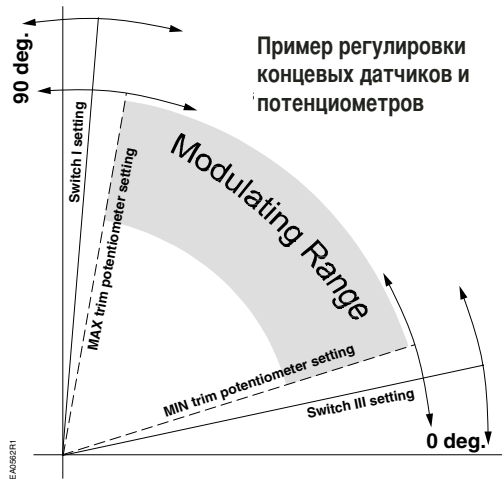
Рис. 13. Установка кулачков и подстроечных потенциометров.
