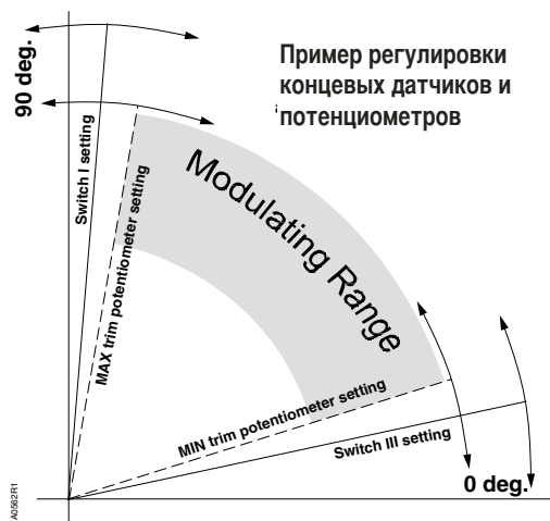
Рис. 13. Установка кулачков и подстроечных потенциометров.
