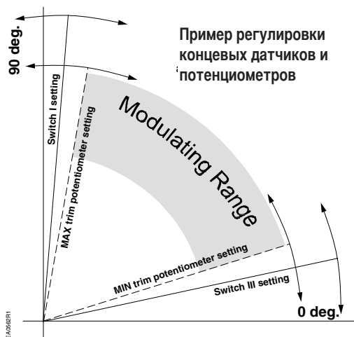
Рис. 13. Установка кулачков и подстроечных потенциометров.
