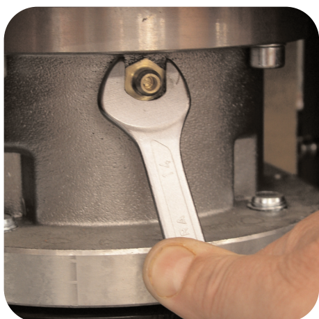
4 – Гаечным ключом размером 14 мм демонтировать штуцер отбора давления.
