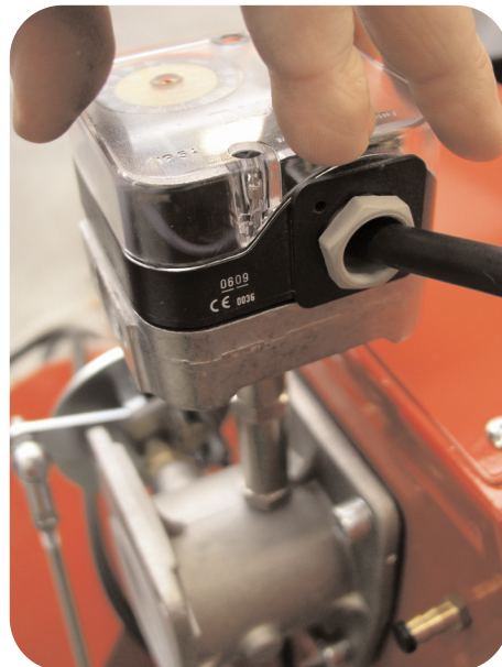
5- Ввинтить реле давления газа (Blu 500-700-1000-1400).
