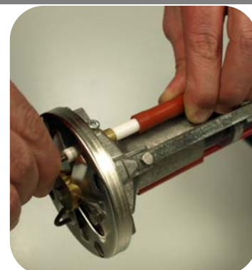
4- Снять провод зажигания и ионизации.
