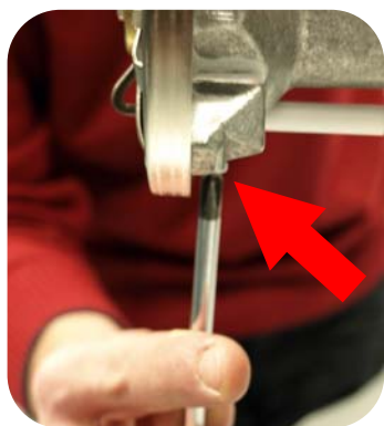
5- Вывинтить крепежный винт электрода розжига.
