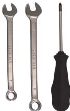
2-Usare una chiave fissa da 7mm.e da 8 mm, un cacciavite a croce medio.
