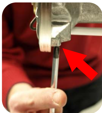
5-Svitare la vite di fissaggio dell'elettrodo d'accensione ed estrarlo.
