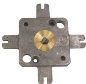
10- Montare la parte anteriore per il GPL cod. BFT12119 (Gas metano cod. BFT12116) di alluminio e il nasello a GPL (Gas metano). Verificare la corretta posizione del nasello sulla bugna di riferimento.
