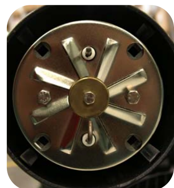
12- Rimontare il boccaglio nel bruciatore.
