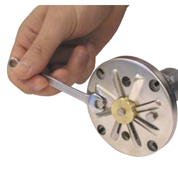
8- Вывинтить крепежные винты и снять рассекатель (ключом на 8 мм).
