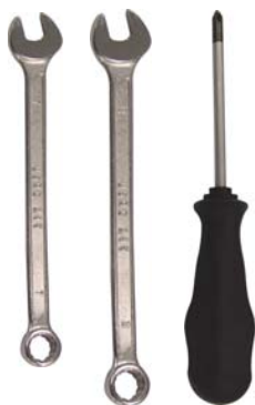
2- Подготовить инструмент: гаечные ключи на 7 и на 8 мм и крестовую отвертку среднего размера.
