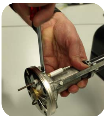
6-Svitare la vite di fissaggio dell'elettrodo di rivelazione e estrarre l'elettrodo di rivelazione
