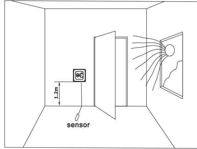
Подведите питающие провода, монтажные концы нагревательной секции, датчика температуры пола к монтажной коробке в гофротрубках. Переведите клавишу выключателя в положение выкл «0». Кратковременно подайте напряжение на питающие провода, индикатором фазы определите фазный провод, пометьте его. Отключите питание 220В. Присоедините провода к клеммам терморегулятора согласно схеме на тыльной стороне терморегулятора.
