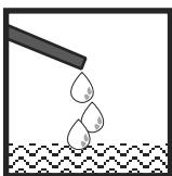
Не допускается стекание конденсата обратно в узел. При низких температурах, в результате обледенения, возможно нарушение и прекращение работы узла.
