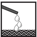
Kondenzat ne smije dosjeti u uređaj. Pri temperaturama ispod nule moguć je neispravan rad/ kvar uslijed smrzavanja.
