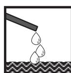
Eviter l'entrée de condensats dans le pressostat, une prise en glace par température négative nuirait à son fonctionnement.
