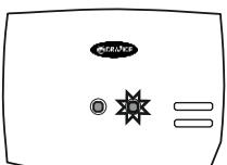
Водонагреватель не греет. Включена активная защита от перегрева спирали.
