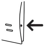
Нажатием на кнопку можно переключать мощность водонагревателя
