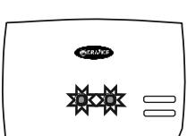
Водонагреватель не греет. Включена активная защита от перегрева спирали. Напряжение меньше 218 В.
